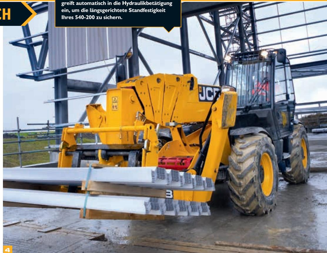
Die adaptive Lastmomentbegrenzung von JCB greift automatisch in die Hydraulikbetätigung ein, um die längsgerichtete Standfestigkeit Ihres 540-200 zu sichern.
