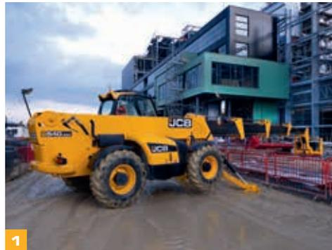
Der Teleskoplader 540-200 bietet kurze Ladezyklen, was der elektronischen Servohydraulik und der leistungsstarken Hydraulikpumpe (110 l/min) zu verdanken ist. Sie können sich auf eine schnelle und produktive Handhabung von Lasten bei Arbeiten in der Höhe einstellen.
