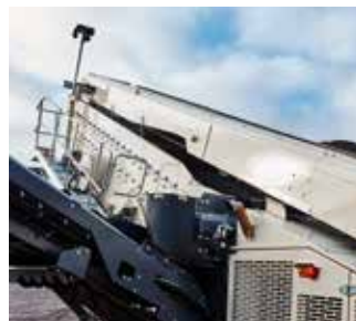
Serienmäßiges hydraulisches Heben des Steigförderbands für mehr Platz bei der Wartung
