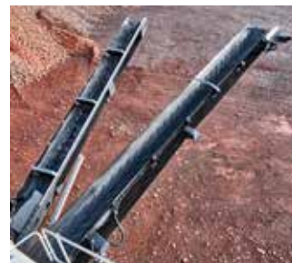
Robuste Chevron-Gurte für Steig-, Überkorn- und Seitenförderbänder für maximale Lebensdauer
