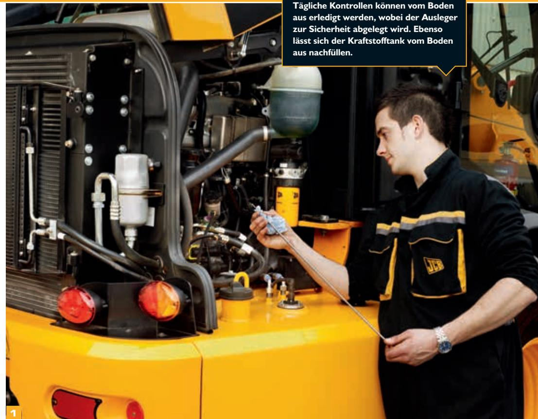
Tägliche Kontrollen können vom Boden aus erledigt werden, wobei der Ausleger zur Sicherheit abgelegt wird. Ebenso lässt sich der Kraftstofftank vom Boden aus nachfüllen.
