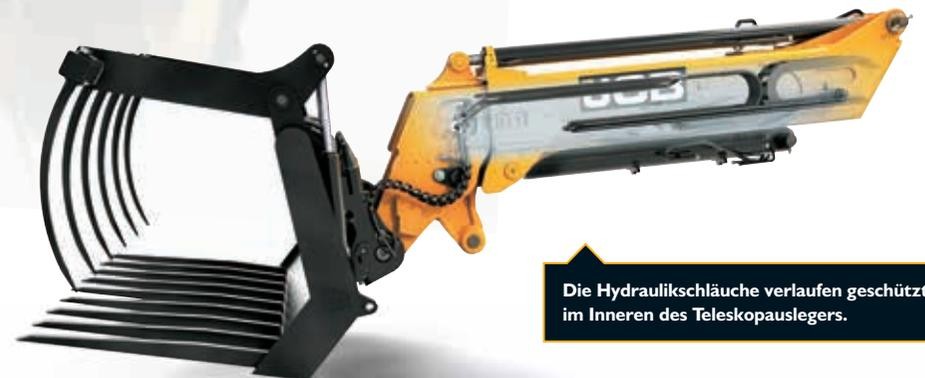
Die Hydraulikschläuche verlaufen geschützt im Inneren des Teleskopauslegers.
