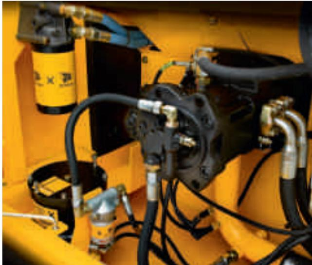
einem hocheffizienten Plexus-Filtersystem, das eine hohe Standzeit der Hydraulikflüssigkeit und Langlebigkeit der Komponenten garantiert.
