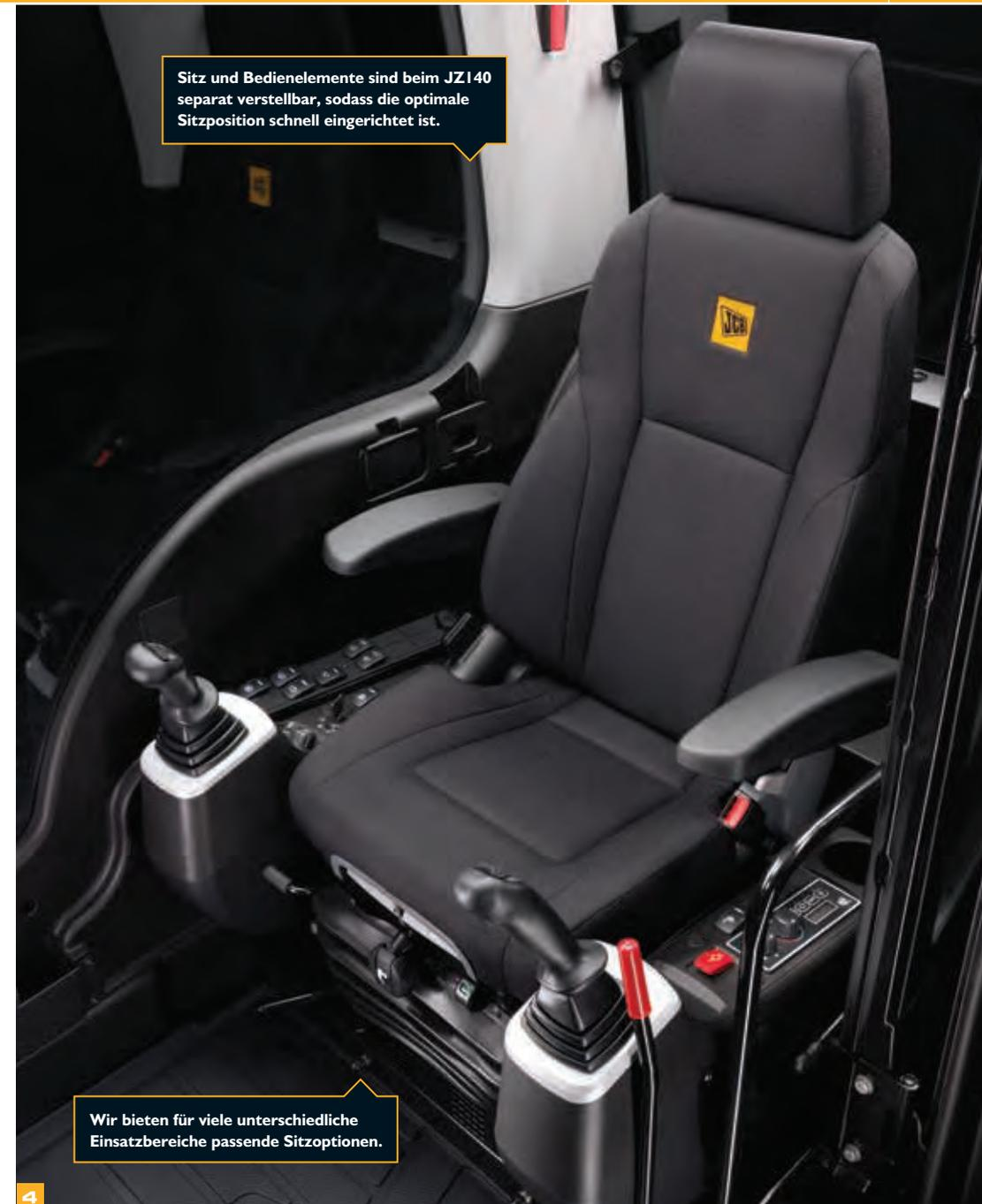
Sitz und Bedienelemente sind beim JZ140 separat verstellbar, sodass die optimale Sitzposition schnell eingerichtet ist.
