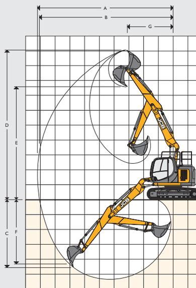
**HUBKAPAZITÄTEN – LÖFFELSTIELLÄNGE: 2,10 M, MONOAUSLEGER 5,70 M, BODENPLATTEN: 500 MM, OHNE LÖFFEL** **JZ140 LC MONO**
