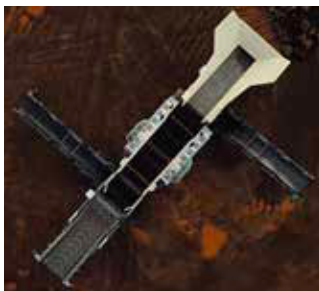
Große Siebfläche und 10 mm Schwingweite für effiziente Materialtrennung
