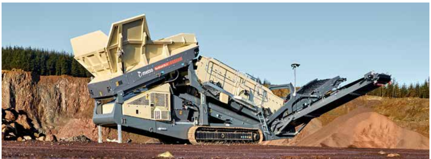
Sechs Not-Aus-Taster, Start-sirene, Motorabschaltung und Schutzvorrichtungen an Klemmpunkten für die Sicherheit
