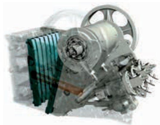
Der Nordberg C96 Backenbrecher mit der aktiven Brechspaltüberwachung Active Setting Control™.
