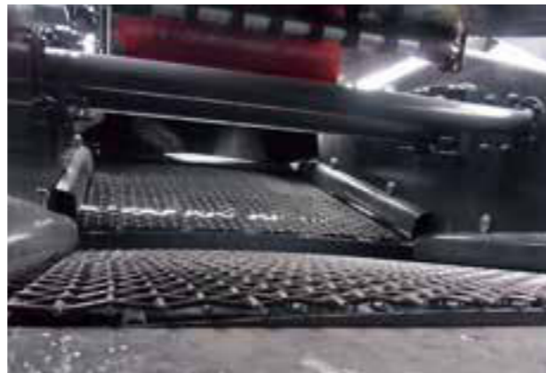
Das Dual-Slope-Sieb ermöglicht die effiziente und genaue Absiebung.
