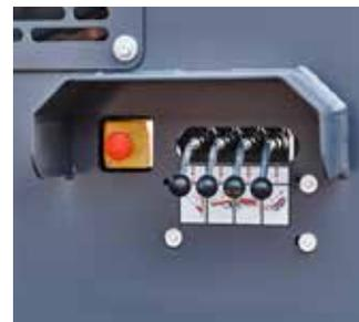
Sechs Not-Aus-Taster, Start-sirene, Motorabschaltung und Schutzvorrichtungen an Klemmpunkten für die Sicherheit
